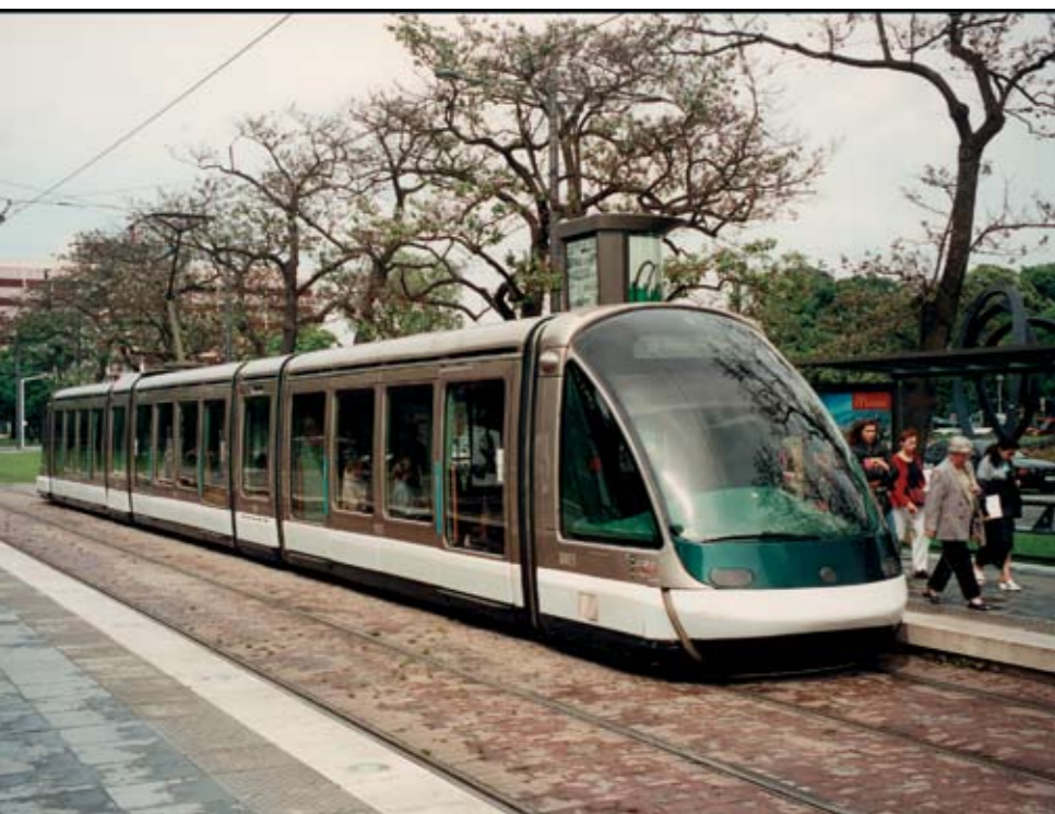
Kommer der moderne lavgulvsporvogne i København. Ja, hvis ikke trafikken skal sande helt til. Denne vogn stammer fra Strasbourg og kan rumme 226 passagerer og betjenes af én mand.
