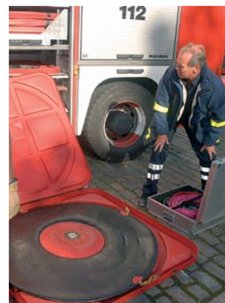
Den runde oppustelige ring kan løfte 132 tons.
